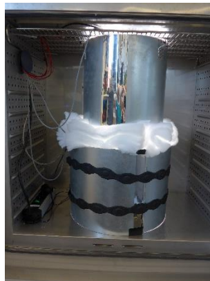
Versuchsaufbau zur Messung der Verdunstungsleistung am ZAE Bayern.
