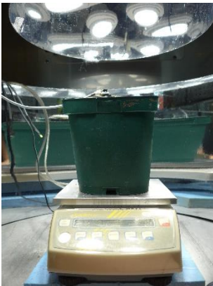
Versuchsaufbau zur Messung der Verdunstungsleistung am ZAE Bayern.
