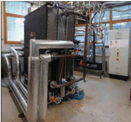
Einstufige AWP & Visualisierung der internen Steuerung
