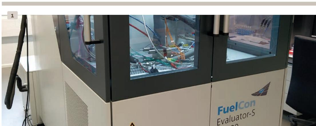
Abb. 1: Vollautomatisierter Teststand für PEM-Elektrolyse-Zellstapel
