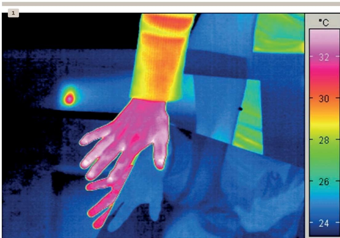
Abb. 1: Eine Wärmebildaufnahme zeigt die wesentlich höhere Reflexion von Wärmestrahlung durch eine Scheibe mit wärereflektierender Beschichtung (links im Bild) im Vergleich zu einer unbeschichteten Scheibe (rechts im Bild).
