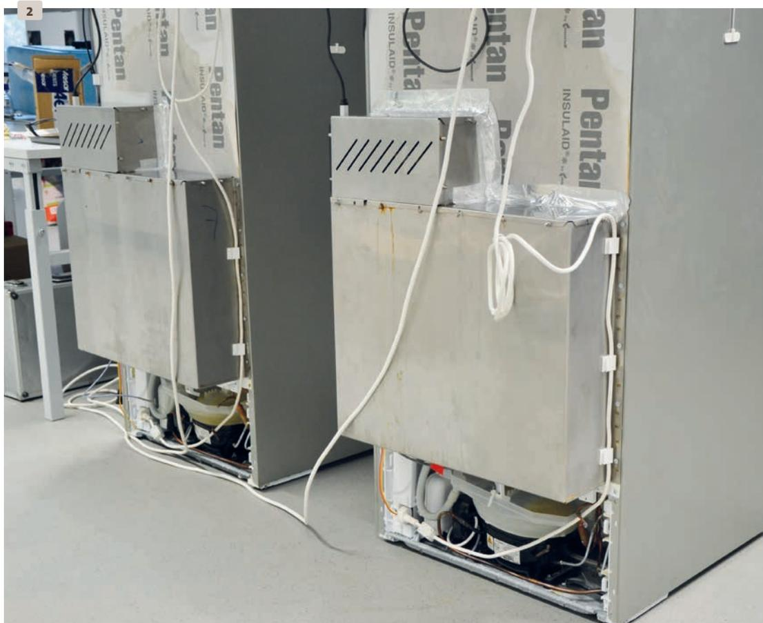
Abb. 2: Die Rückseiten zweier Kühlschranksprototypen mit aufgesetztem Kältespeichermodul.
